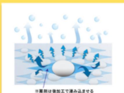
レイシスは製造時に高温加熱を必要としないため、従来では蒸発・分解してしまう薬剤も低温で浸み込ませることが可能です。しかもフィルム体積の最大40%まで溜め込むことが可能。そのため、これまでは出来なかった薬剤のフィルム製品化や、従来比約4倍のパフォーマンス向上が可能となります。
